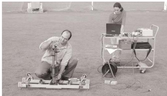
Figura 2. Ensayo de amortiguación con atleta artificial.
