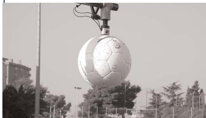
Figura 3. Ensayo de bote vertical.
