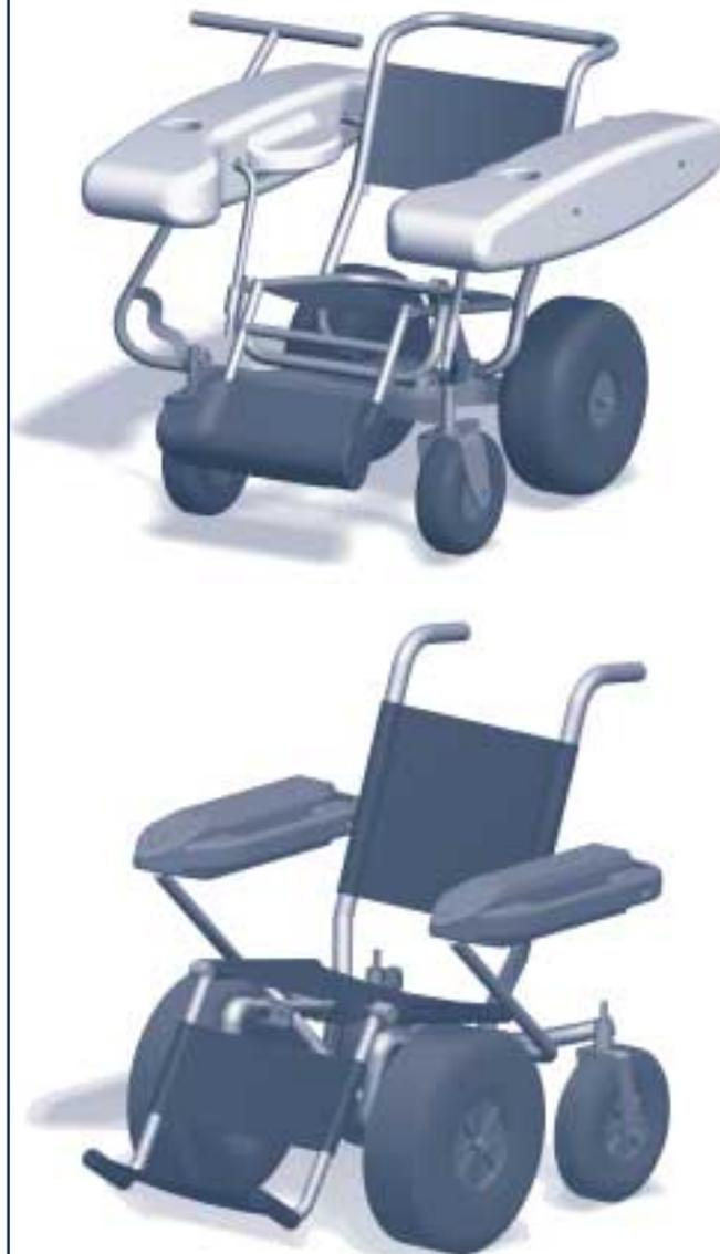
Figura 2. Diseños conceptuales de la silla anfibia creados a partir de las especificaciones de diseño. La principal diferencia entre ambas configuraciones reside en la disposición de las ruedas y en el sistema de plegado.
