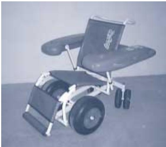
Figura 5. Prototipo funcional de la silla anfibia.
