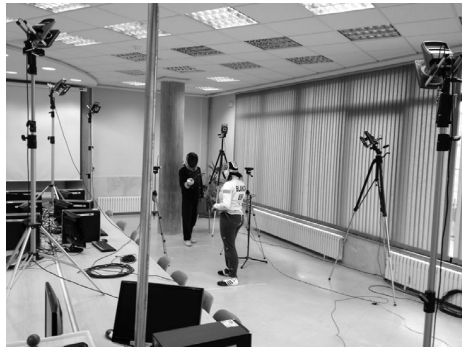
FIGURA 1: Sistema telemétrico de cronometraje con fotocélulas láser (DSD Laser System, León, España) y sistema Vicon de análisis 3D
