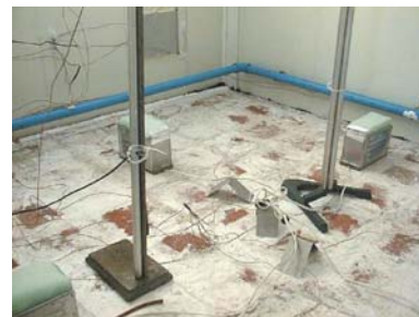
Figura 8. Ensayo con piso de alta inercia térmica
