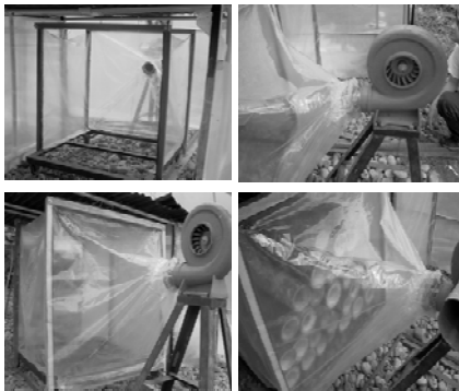
Fuente: Autores Figura 4. Detalle flujo de aire caliente a través del dispositivo cónico a la salida del ventilador centrífugo.
