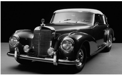
Fig. 1. Mercedes 300 S Roadster (1951). El estilo de su carrocería mantenía características propias de los automóviles de antes de la Segunda Guerra Mundial: aletas marcadas, estribos, capó mucho más alto que las aletas delanteras, paños de las puertas delanteras no planos... Foto tomada de Internet.
