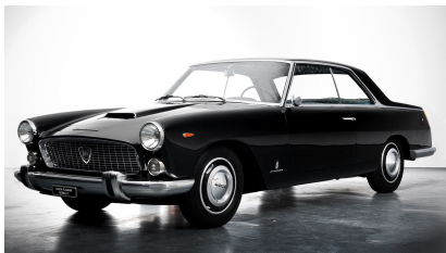
Fig. 4. Lancia Florida II (1955). Diseño en el que alternan las aristas vivas con las zonas redondeadas. Aletas traseras con su borde superior no redondeado, parabrisas panorámico y capó a la altura de las aletas delanteras, o más bajo. Foto tomada de Internet.
