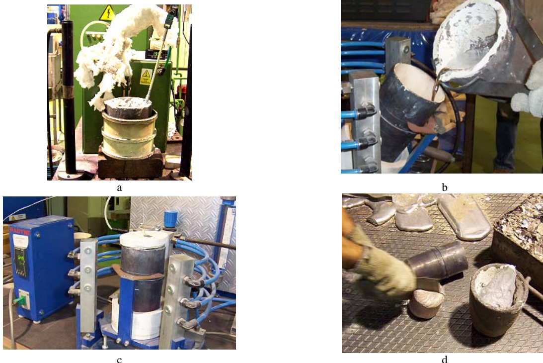
Figura 2. Etapas del reocalado de la aleación A-356 por NRC: (a) Fusión de la aleación en un horno de inducción, (b) Colada en un crisol de acero precalentado, (c) Enfriamiento controlado (d) Lingote de aleación reocalada (corte con un cuchillo)
