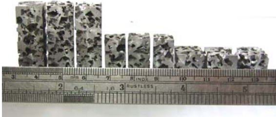
Figura 4. Probetas utilizadas para el cálculo de densidad y los ensayos de compresión
