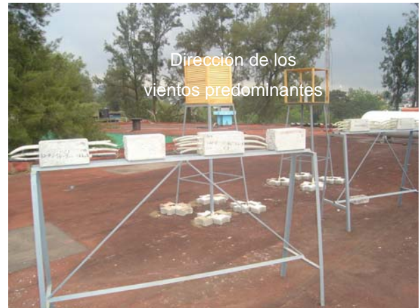
Figura 1. Fotografía de la estación de ensayo natural, orientada hacia los vientos predominantes.
