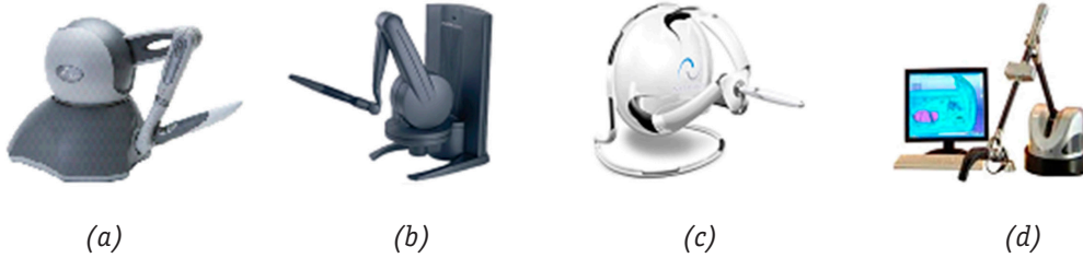
Figura 1: Sistemas hápticos comerciales: a) phantom omni, b) phantom desktop, c) falcon, d) virtuoso.
