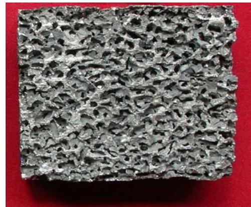
Figura 2. Microestructura de aleación Mg-Al porosa.
