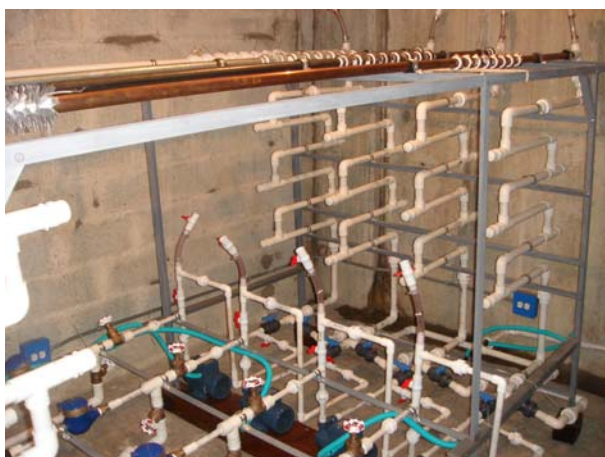
Figura 1. Sistema experimental de pilotos de tubería.
