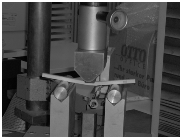
Figura 4. Ensayo de flexión de una probeta de Guadua.
