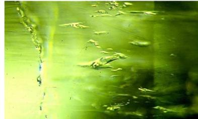
Fig 9. Inclusiones trifásicas sólido-líquido-gas en esmeralda
