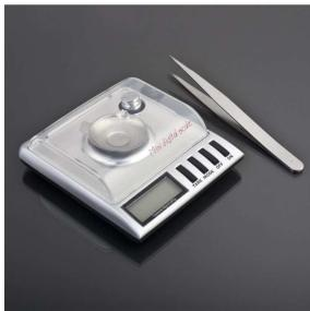
Fig 2. Balanza de precisión
