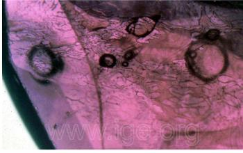
Fig 7. Inclusiones líquidas en rubí
