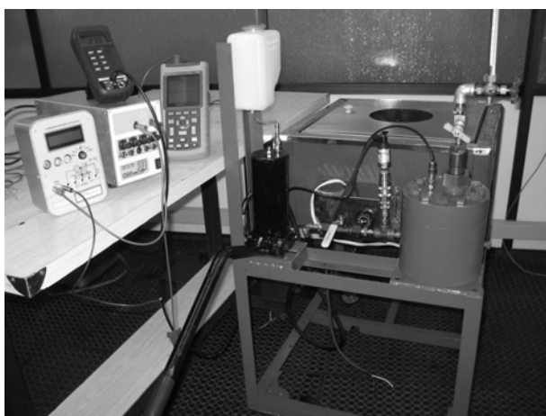
Figura 2. Sistema para medir la compresibilidad isotérmica de aceites minerales
