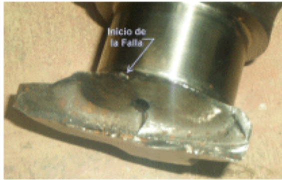
Figura 7: Detalle de la superficie de fractura del cigüeñal truncado.
