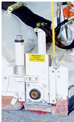
Figura 2. Unidad con cepillos flotantes [15]
