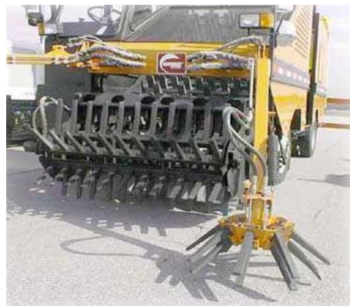
Figura 3. Sistema con dedos de recolección [26]
