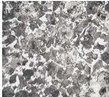
Figura 5. Corte transversal en la zona de la falla a 400X
