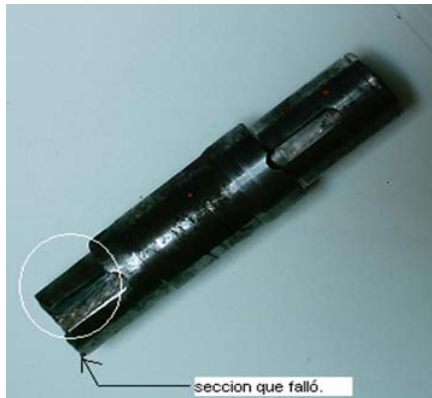
Figura 2. Vista lateral zona de falla
