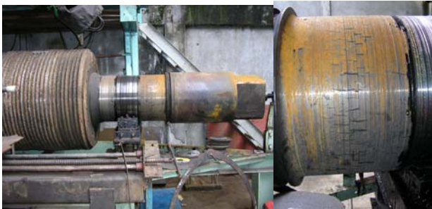
Figura 1. Eje de molino con fisuras longitudinales.
