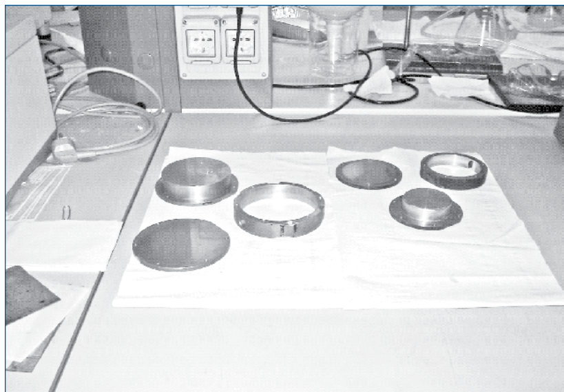
Figura 3. Moldes de latón usados para el film de nanocompuesto polimérico termoestable
