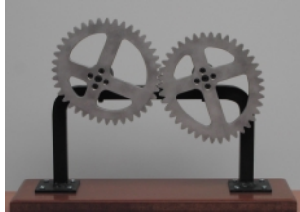
Figura 8. Ruedas mecanizadas por CNC. [1]
