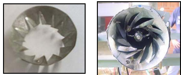
Figura 2. Estabilizadores de llama
