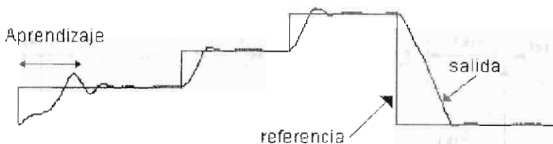
FIGURA 2. Aprendizaje y respuesta de la salida para varios comandos de referencia (Escala de tiempo = 5s/div)
