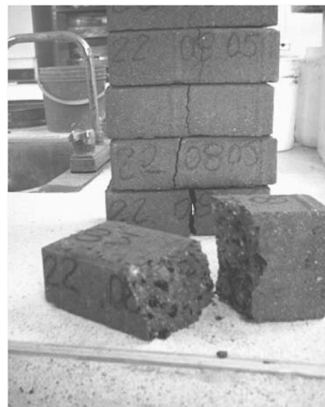
Foto 6. Adoquín después de ensayar
