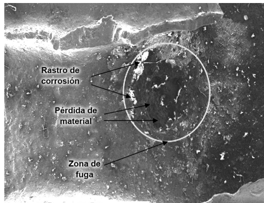
Figura 15. Probeta 2-1, aumento a 50X (Al estar la fuga paralela a la placa no se pudo observar en el SEM la fuga, debido a que el SEM solo permite observar perpendicular a la placa e inclinarla hasta cierto ángulo, ángulo que no fue lo suficientemente grande para este caso. Se nota una pérdida de material y manchas blancas que es presencia de corrosión en la zona de fuga).
