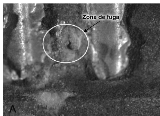
Figura 13. A) Placa 3-21-1, primera zona de fuga aumento a 2,5X. B) Placa 3-22-2, segunda zona de fuga aumento a 3,2X (Se evidencia una corrosión generalizada en todo el borde de la placa el cual en su mayoría estaba cubierto por depósito de suciedad, las zonas de color claro es presencia de corrosión).
