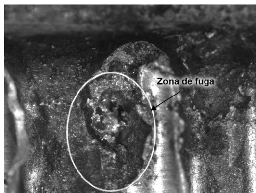
Figura 11. Placa 1-2, aumento a 2X (Se evidencia la fuga en una zona de pérdida de material que se encontraba cubierta por depósito, este depósito cubría gran parte del borde de esta placa).
