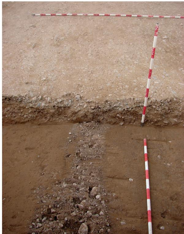
*Figura 4. Surco de replanteo de la vía altoimperial mediante una arada, rellena posteriormente de la primera tongada de zaborras del tronco.*
