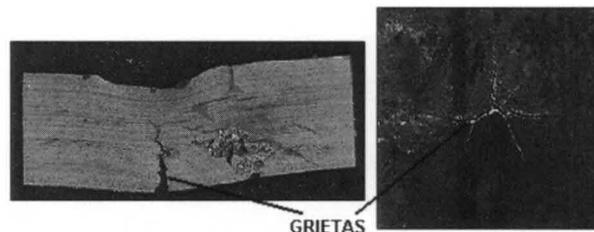
Figura 15. Grietas transversales de la superficie opuesta al impacto del proyectil 5,56 SS109 sobre LSAE1045B3.
