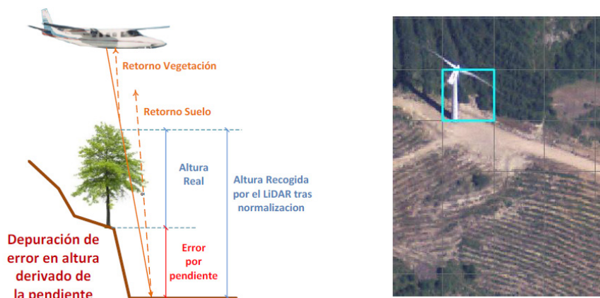
Figura 4 Ejemplo de error por pendiente (izquierda) y por presencia de aerogeneradores localizados en celdas de terreno agروفorestral (derecha)
