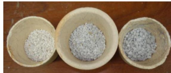
Fig. 7. Preforma luego de la prueba de calentamiento
