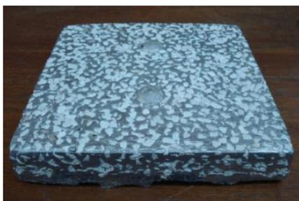
Fig. 8. Esponja infiltrada sin remoción de preforma
