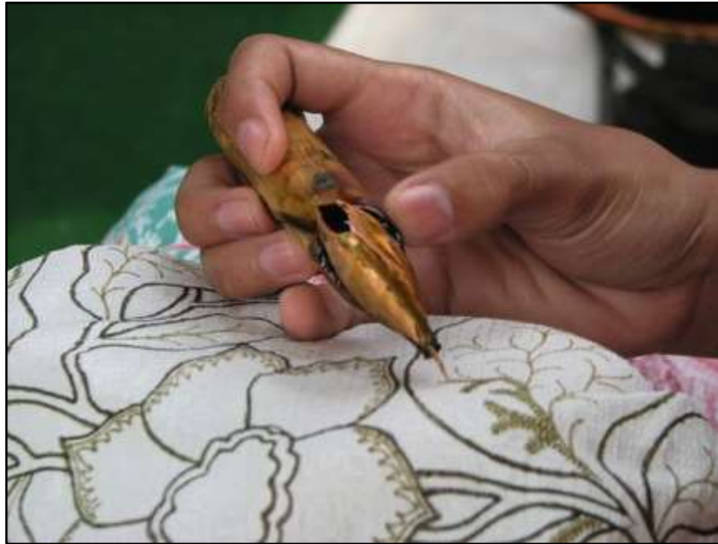
Foto 1. Canting, herramienta rústica para dibujar con cera caliente sobre la tela. Fuente: www.unesco.org/culture
