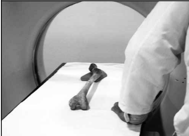
Figura 7. Tomógrafo dual multicorte utilizado en las tomas de imágenes de la sección transversal.
