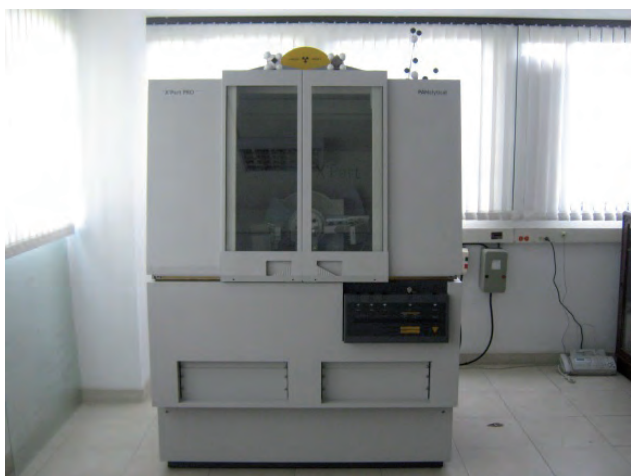
Fotos 4 y 5. Equipo X'pert pro marca PANalytical, para la difracción de rayos X
