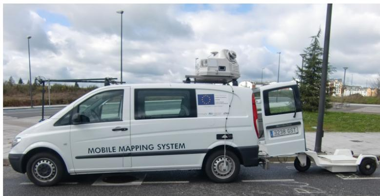
**Fig. 18: Unidad Móvil de Inspección SITEGI con remolque definitivo para la implementación de antenas GPR.**
