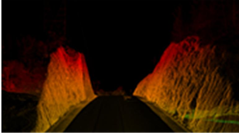
**Fig. 6:** Análisis geométrico y de estabilidad de **taludes** en la carretera OU-105 con LiDAR. Ortoimágenes 3D obtenidas con técnicas LiDAR.
