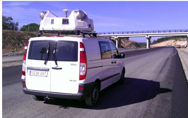
**Fig. 4: Control geométrico de firmes** con la Unidad Móvil de Inspección en las inmediaciones del PK 0+200 de la Autovía Ourense-Celanova.
