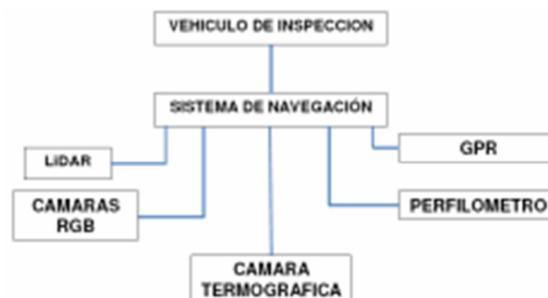
**Fig. 1: Esquema general** del sistema de inspección y control SITEGI.
