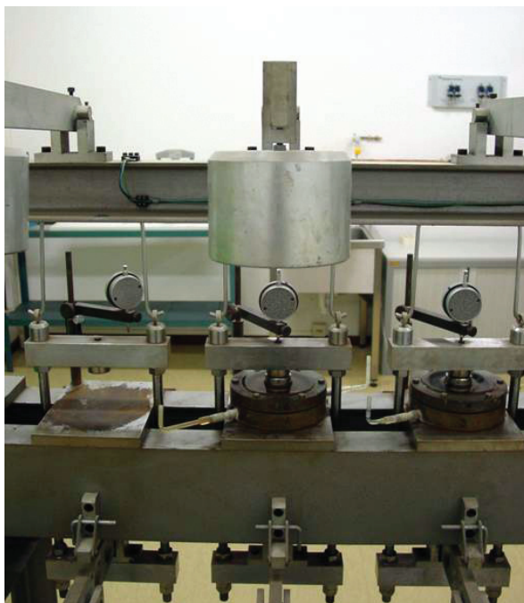
Fotografía 1 Ensayos de edómetro
