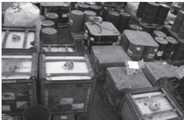
Figura 7. Aditivos químicos del fluido de fractura en campo Fuente: Carrascal F. y Pachón Z. [29].
