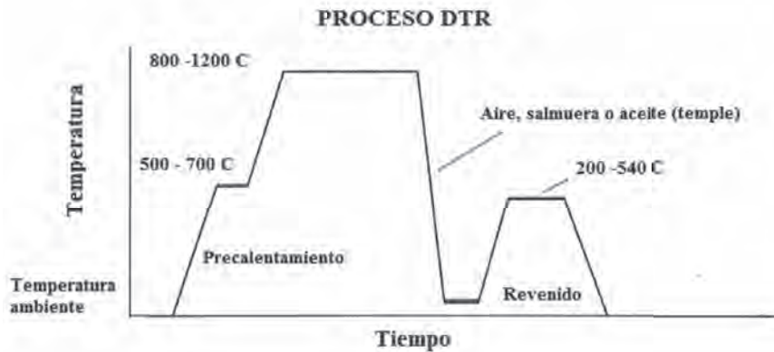
Figura 1. Ciclo típico de tratamiento térmico en el proceso DTR [1]
