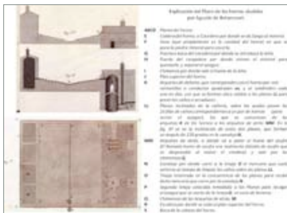
Figura 11. Planta y alzados de un par de hornos aludeles. (Fuente: BETANCOURT, A., 1783)
