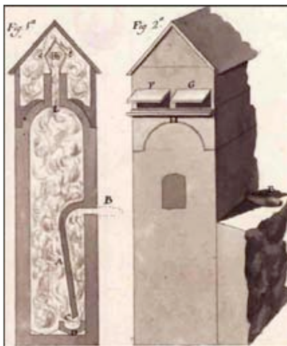
Figura 14. Innovaciones realizadas en los hornos aludeles en Idria. (Fuente: BETANCOURT, A., 1783)
