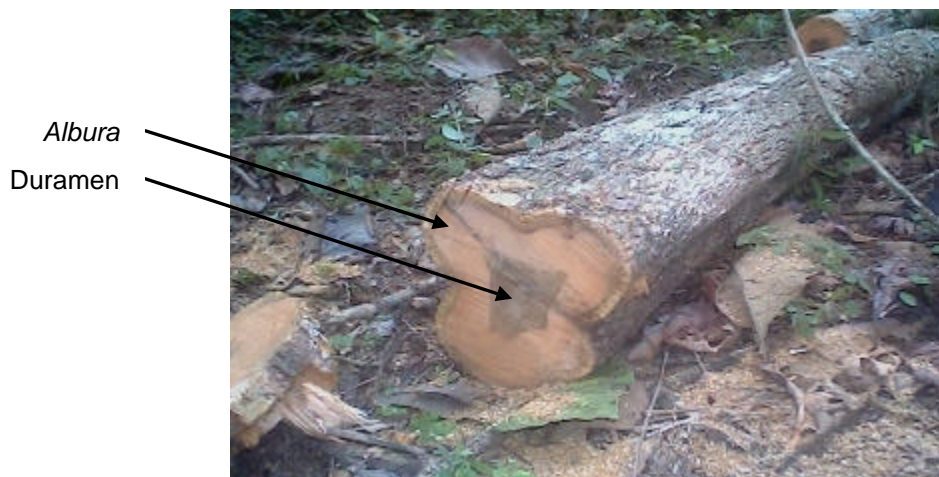
Figura 4. Diferencia entre duramen y albura en Tectona grandis Linn. F. (teca) de 8 años, Valle de Sacta, Cochabamba, Bolivia.
