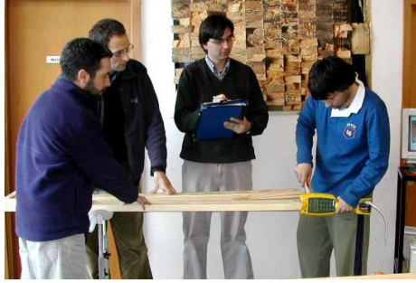
Figura 2. Medición de la velocidad del sonido con Director HM200. (Fuente: www.fibre-gen.com , s.f.).
