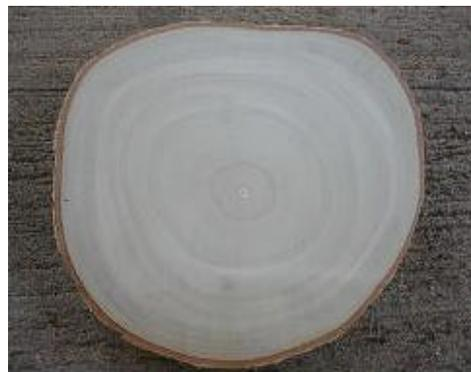
**Madera de reacción:** sección de una tabla recién cortada mostrando las bandas más claras de “madera de reacción”. Se ha encontrado que esta madera más clara tiene una menor densidad, menor dureza y propiedades mecánicas en general inferiores a la madera normal.
