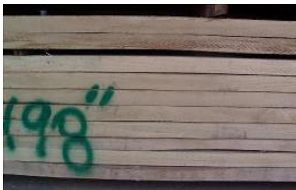
**Encorvadura:** la curvatura de uno de los cantos de una pieza de madera en el sentido longitudinal de la tabla, ocasiona una encorvadura. En este caso la curvatura es severa y mide alrededor de 2 cm. Frecuentemente esta torcedura se presenta durante el aserrío, como consecuencia de la liberación de los esfuerzos de crecimiento presentes en piezas procedentes de las partes de la troza cercanas a la médula. Posteriormente puede verse modificada por las contracciones producidas durante el secado.
