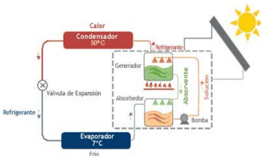
Fig. 1. Sistema de refrigeración solar por absorción.
