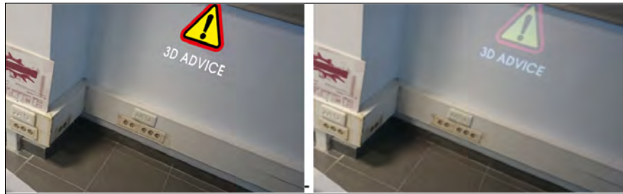
Figura 1. RA convencional (izquierda), la información se visualiza a través de una pantalla. Realidad aumentada en el sitio (derecha), la información se proyecta y observa en el entorno.
