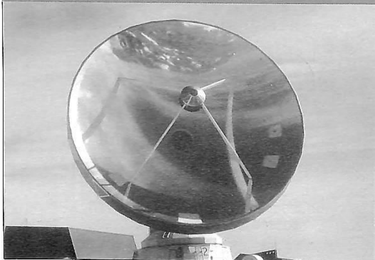
FIGURA 8. SE APRECIA LA SUPERFICIE DE UN RADIOTELESCOPIO FORMADA POR MUCHOS PANELES INDIVIDUALES. LOS PANELES TIENEN UNA SUPERFICIE MUY LISA Y EL EMPALME ENTRE CADA UNO DE ELLOS ES ÓPTIMO, DE TAL FORMA QUE EL CONJUNTO DE ELLOS ASEGURA UNA FORMA PARABÓLICA DE LA SUPERFICIE. EN LA FOTO SE PUEDE APRECIAR EL TAMAÑO INDIVIDUAL DE UN PANEL PUES EXISTE CONDENSACIÓN SOBRE DOS DE ELLOS EN EL MOMENTO EN QUE SE TOMÓ LA IMAGEN. NÓTESE QUE LA SUPERFICIE ES CASI UN ESPEJO. EL RADIOTELESCOPIO ES UNO DE TRES QUE FORMA PARTE DE UN SISTEMA CONOCIDO COMO RADIO INTERFERÓMETRO Y SE ENCUENTRA EN LAS MONTAÑAS DEL SURESTE DE FRANCIA. PERTENECE TAMBIÉN AL IRAM Y SE DISEÑÓ PARA DETECTAR RADIACIÓN A LONGITUDES DE ONDA MILIMÉTRICAS.
