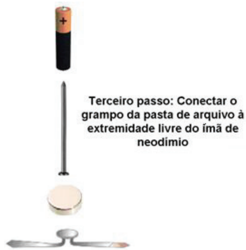
Fig. 4 – Terceiro passo da montagem da demonstração.
