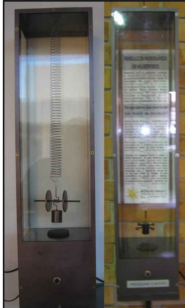
Fig. 6 – Pêndulos de Wilberforce da instituição em que se encontram os autores. O do lado esquerdo seguiu a montagem da primeira subseção e pertence a um laboratório didático. O do lado direito pertence ao MCT. A única diferença entre eles é que o do lado direito apresenta quatro hastes ('braços') com pequenas massas de latão nas extremidades, cujo momento de inércia fora ajustado por acréscimos de massas de calafetar (visualmente camufladas na pintura) seguindo orientações de Ehrlich (1990).
