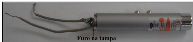
Fig. 1 – Foto do laser vermelho com fios tipo cabinho soldados nos terminais de alimentação positivo e negativo. O fio que atravessa o furo da tampa é soldado na mola interna (terminal negativo).
