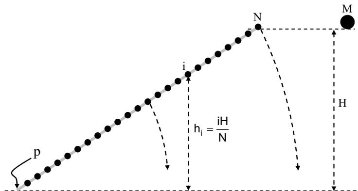
Fig. 3 - A “haste” é representada dessa vez por  $N$  esferas, cada uma de massa  $M/N$ . A  $i$ -ésima esfera está a uma altura  $h_i = iH/N$  do solo. Durante a queda, como das outras vezes, a extremidade esquerda da “haste” gira em torno do ponto  $p$ .
