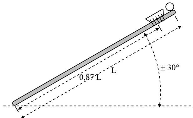
Fig. 4 - Sugestão de aparato experimental para descobrir experimentalmente quem chega antes ao solo: a extremidade da haste ou a esfera de massa de modelar. Note que a haste inicia sua queda formando um ângulo de cerca de  $30^\circ$  com a horizontal.
