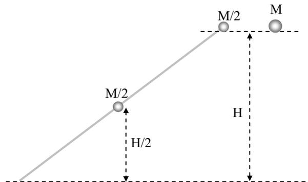
Fig. 2 - Uma haste “simplificada”, constituída de uma vareta sem massa, munida de duas esferas de massa  $M/2$ , uma no meio e a outra na extremidade livre. Quem chega ao solo com velocidade maior: a esfera da extremidade livre da haste, ou a outra esfera solitária, de massa  $M$ , em queda livre?
