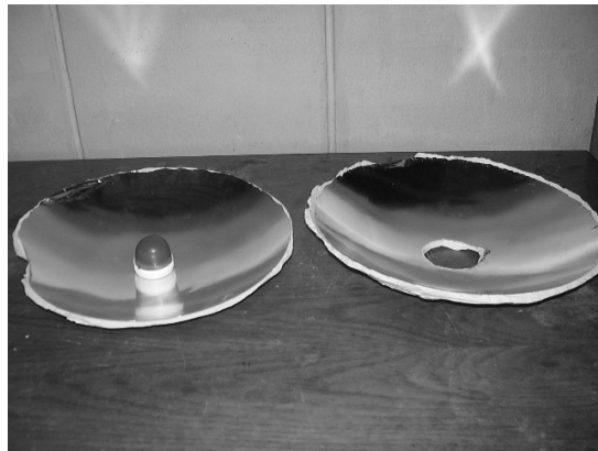
Fig. 8 - Espelho côncavo produzido com papel laminado esticado sobre uma superfície polida.
