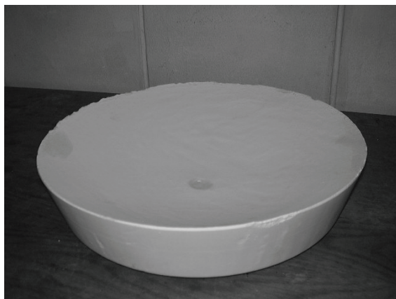
Fig. 3 - Molde parabólico de gesso solidificado pelo método das imagens focalizadas.
