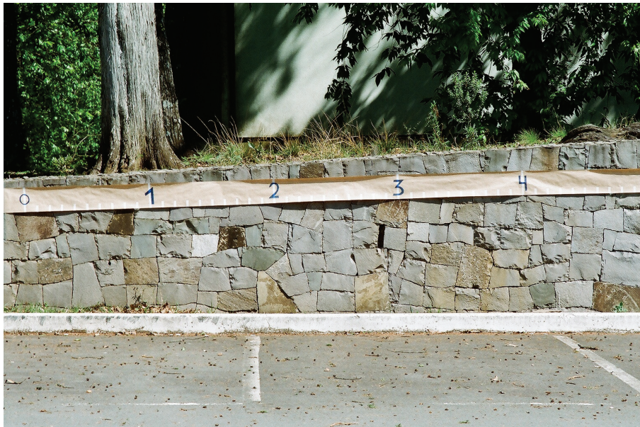
Fig. 3 - Foto obtida com uma teleobjetiva de distância focal igual a 135 mm, a 20 m de distância de uma escala, graduada em metros, e com divisões menores de 10 em 10 cm. Note que a dimensão da imagem i , que corresponde à largura total do quadro, pode ser lida diretamente na fita graduada é, aproximadamente, 5,15 m.
