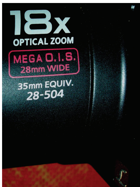
Fig. 4 - O zoom de uma câmara digital. As distâncias focais vão de 28 mm (dado equivalente ao de uma câmara 35 mm) até 504 mm ( idem ).
