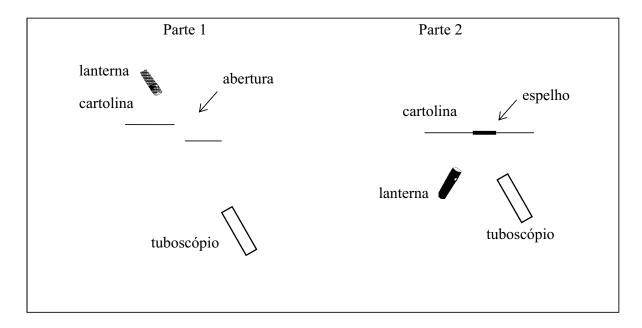
Disposição dos elementos (vistos de cima) para realização da experiência do "tuboscópio"
